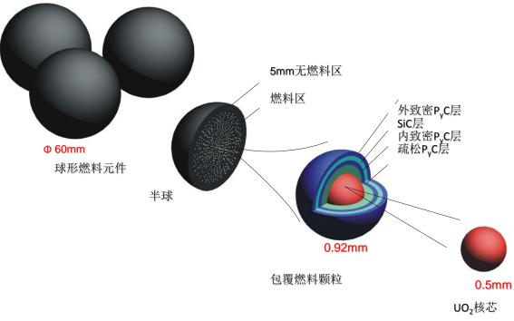
高温气冷堆球形燃料元件示意图
